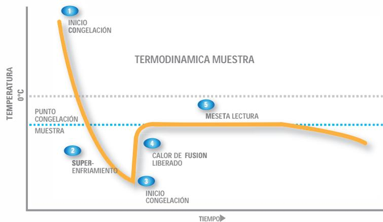
Los osmómetros Advanced utilizan el método de punto de congelación preferido por la Industria de determinar la osmolaridad de una solución acuosa. Cuando una solución contiene solutos mas bajo que el de la solución sola. Cuando más soluto se añade, el punto de congelación disminuyemas deprisa. Así midiendo con precisión el punto exacto de congelación de la solución, la osmolaridad o concentración puede ser determinada
